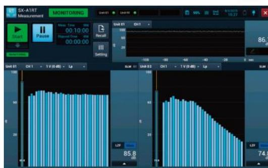
Mesure du bruit dans 2 salles en simultanée
