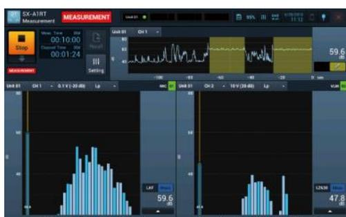
Analyse 1/3 d'octave multivoies temps réel
