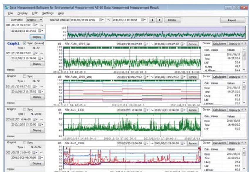
**AS-60RT****Analyse par bande d'octave et de 1/3 d'octave****Affichage simultané de plusieurs ensembles de données de mesures**
